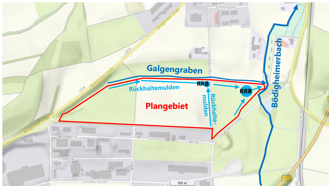
Abb. 12: Skizze Konzeption Ableitung Niederschlagswasser
