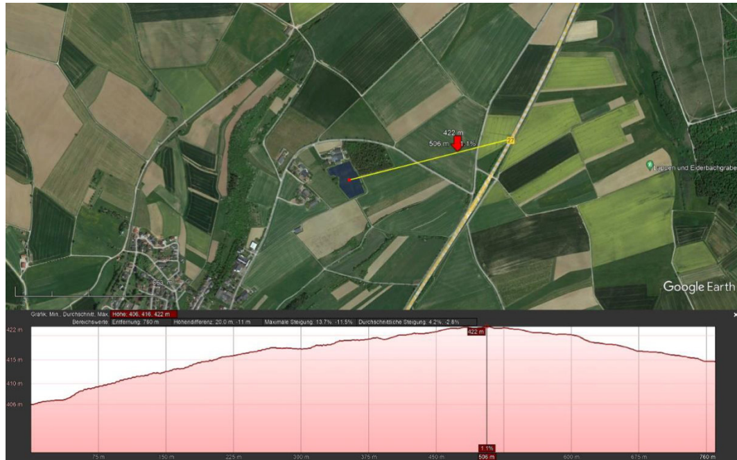
Abbildung 6: Höhenprofil zwischen Photovoltaikanlage und Punkt B5
